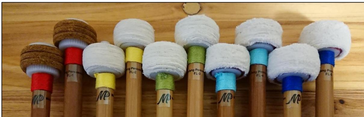
Die Schlägelköpfe in dieser Serie bestehen aus mehreren gestapelten Lagen Stoff oder Leder, die auf einem Nylongewinde befestigt sind, welches fest im Bambusstiel verklebt ist. Im Vergleich zu Holzgewinden sind die Nylongewinde deutlich robuster und langlebiger. Die obere Kunststoffmutter lässt sich bei allen Modellen abdrehen, wodurch sich die Scheibenanzahl und die Härte des Kopfes individuell variieren lassen.
